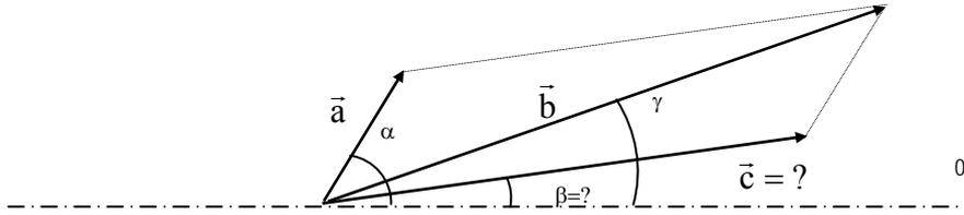
Pour soustraire deux vecteurs, il suffit de prendre l'**extrémité** du vecteur à soustraire et de le placer à l'**extrémité** de l'autre vecteur, puis de mesurer la distance entre l'**origine** du 1<sup>er</sup> vecteur et l'**origine** du 2<sup>ème</sup> vecteur.
