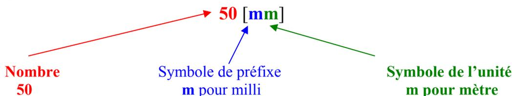
On prononce 50 millimètres, le préfixe remplace une puissance de 10, qui dans cet exemple vaut :  $1 \cdot 10^{-3}$
