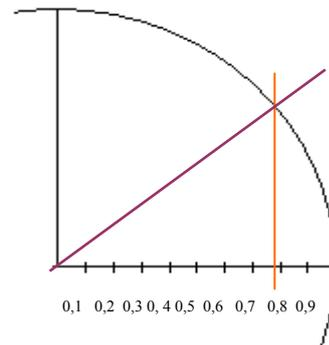
**Exemple 1 :** La tension d'alimentation  $U_z$  d'un circuit RL série est de 230 [V]. Le cos phi est de 0,75. Que valent les tensions  $U_r$  et  $U_1$  ?
