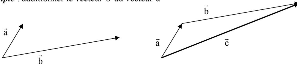
L'origine de  $\vec{b}$  est placée à l'extrémité de  $\vec{a}$  :  $\vec{a} + \vec{b} = \vec{c}$
