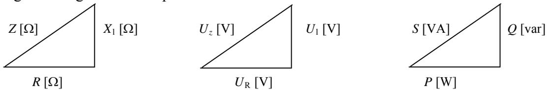
Nous pouvons résoudre ces problèmes soit par calcul soit à l'aide d'un graphique en superposant les caractéristiques du circuit électrique et le cercle trigonométrique (unitaire).
