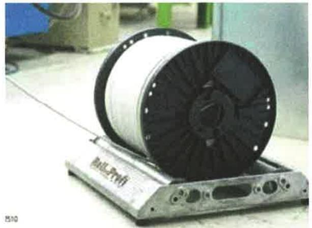
**Figure 33:** Direction inappropriée pour le déroulement
