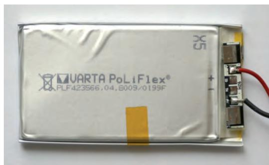
Accumulateur Li-po avec circuit de protection.
