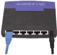
Face arrière d'un switch avec prises RJ45.
