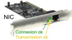
Afin de pouvoir exploiter les avantages d'un réseau local (LAN), l'ensemble des périphériques doivent y être connectés via une carte réseau Ethernet (NIC).
