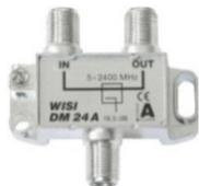
Les dérivateurs permettent de dévier un signal à **différents** segments. Un dérivateur a toujours une entrée, une sortie de base et une ou plusieurs sorties de connexion. L'atténuation dérivée des sorties de connexion est plus importante que l'atténuation de passage.
