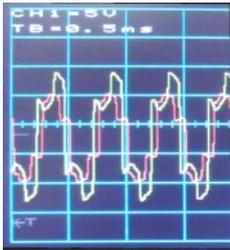
Mesure sur ligne bifilaire ouverte de 100 m jaune entrée, rouge sortie Cf. essai [TM2.5.7].
