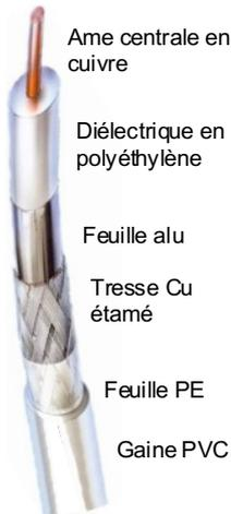
Les câbles coaxiaux sont des câbles asymétriques. L'âme centrale est constituée d'un fil en cuivre entouré d'un diélectrique en polyéthylène. Autour de celui-ci, il y a un ou plusieurs blindages en feuilles et un blindage en cuivre tressé, qui protège le câble des champs électriques (mais pas des champs magnétiques !). Le câble est protégé contre la pression et l'humidité par une isolation en PVC.
