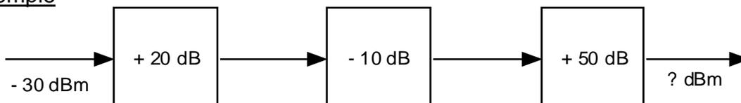
Calculer le gain ou l'affaiblissement à la fin de la chaîne électroacoustique ci-dessus. Calculer le niveau du signal en dBm à la sortie.
