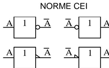
Remarque: En norme CEI, la pointe du triangle sur la ligne indique la direction de propagation de l'information.
