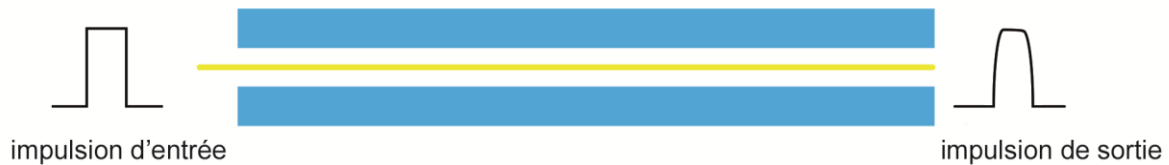
Fig. 5: Propagation de la lumière dans une fibre single mode
