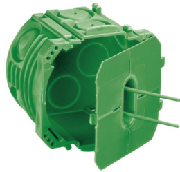
Boîte d'encastrement gr1 77 x 77 [mm] fixation 70 x 70 [mm] forage diamètre 71 [mm]
