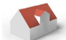
Lucarne en pignon
