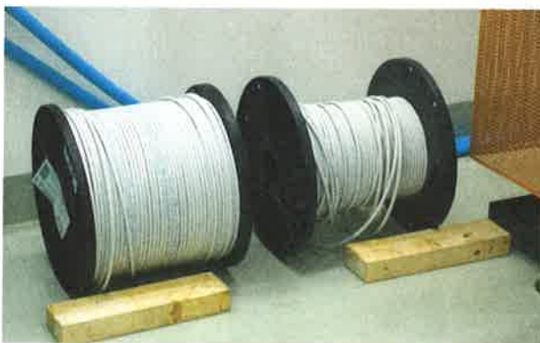
Figure 44: Correct: stockage des câbles en cuivre dans un endroit sec
