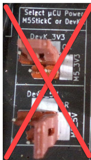
Abbildung 15: gemischte Spannungsversorgung vermeiden
