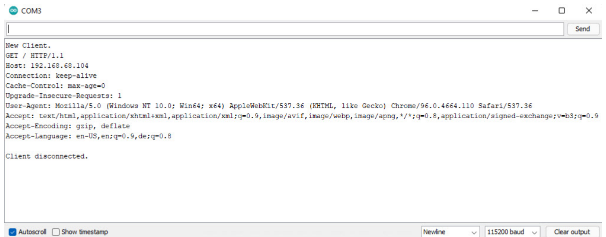
Abbildung 79: Hier eine Clientverbindung mit dem Chrome-Browser Zugriff mit Browser auf den Webservice des ESP32:
