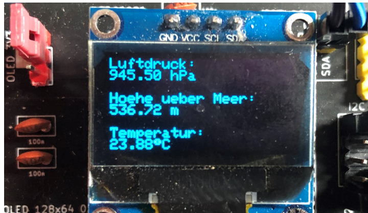
Abbildung 52: Ausgabe der Sensorwerte des BMP388 auf dem OLED-Display. Hier ebenfalls mit der berechneten Höhe über Meer.
